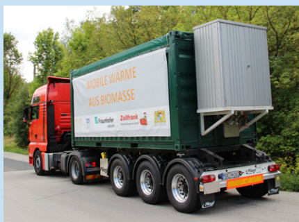
Transport der Wärme vom Erzeuger zum Abnehmer.
